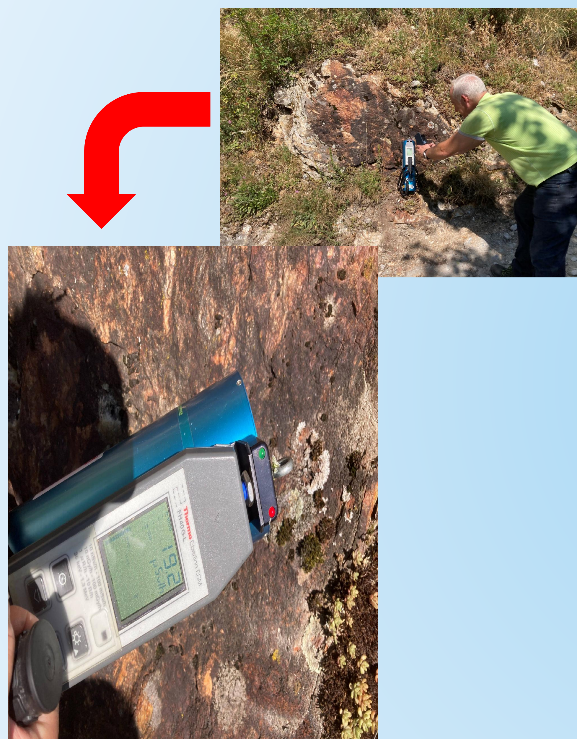
Fig.2 – Misura in campo di un filone uranifero (19.2 μSv/h) in provincia di Cuneo.
