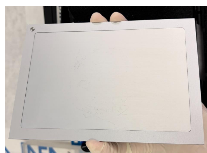
Fig. 2: Sorgenti piane estese dell'ENEA-INMRI usate per l'interconfronto.
