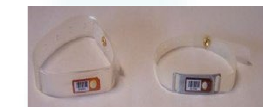
Figura 2: dosimetro di GR200 con supporto ad anello Figura 1: Dosimetri per estremità con supporto ad anello, bracciale e bracciale sterilizzabile.
